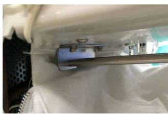
10.ウエスト部のブラケットを布の通し、ボルトに布、ブラケットを通します。
