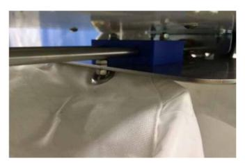
11ブラケットにボルトを通して、ステンレスのナットを先に入れ、鉄ナットを締めて固定します。
