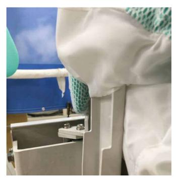
作業がしにくいときはエアチューブをシリンダから抜き、シリンダをフリーにしてください。 If it is difficult to work, remove the air tube from the cylinder and free the cylinder.
