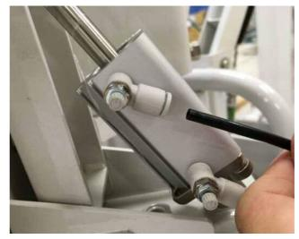
スパナで継手を押しながら、チューブを抜きます。
