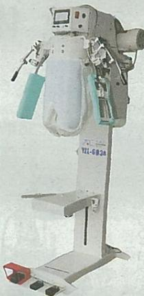
制御盤付近の構造を変更し、メンテナンス性を向上。パネルの取り外しができる。ラジエーター確認
