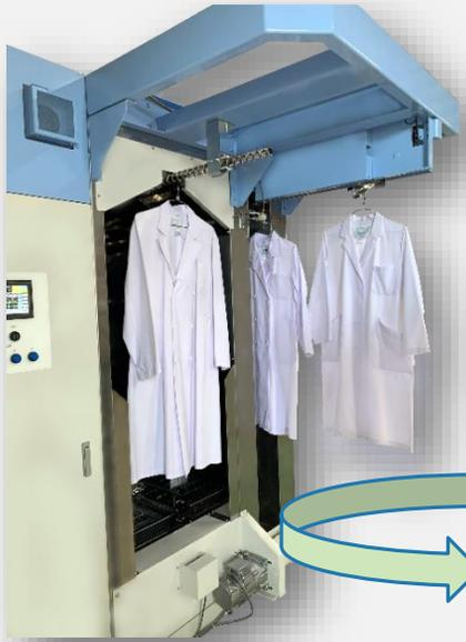
横向きに品物を挿入し、脱水時に付いたシワを蒸気的水分と熱でほぐし熱風吹き下ろしによる揺動でシワを伸ばします。
