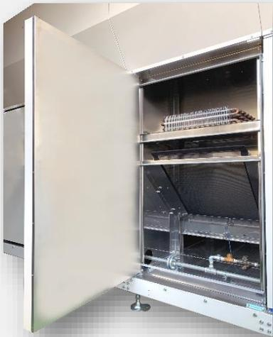
大型リントフィルターを装備扉を開ければ面倒なフィルター掃除やヒーターのリント掃除も簡単楽々
