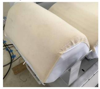
11.カバー布をスプリングで固定します。 Pull the cover cloth with a spring
