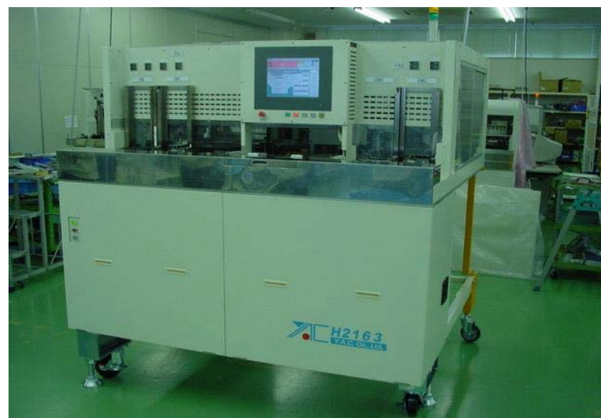
新製品 ICテストハンドラー(16個同時測定・常・高温タイプ)
