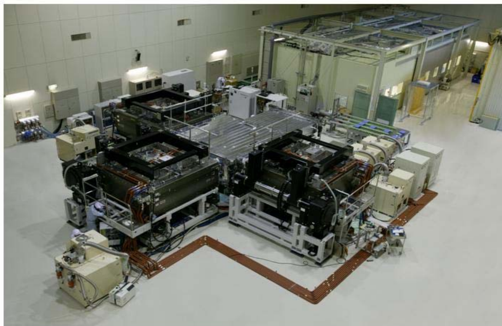
第7世代用プラズマ・ドライ・エッチング装置(3チャンバータイプ)
