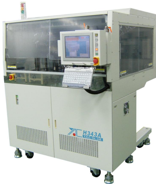
A/H343 : 4個同時測定、常・高温タイプ、 低振動、低発塵
