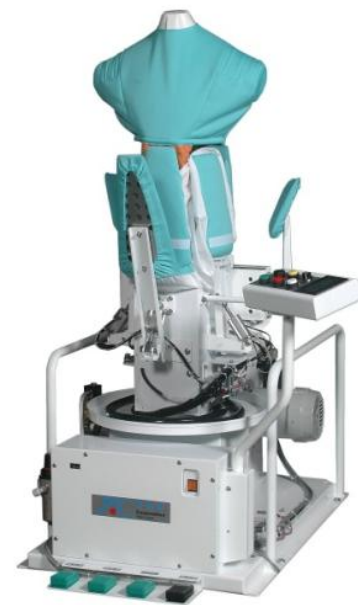
ジャケット仕上機
