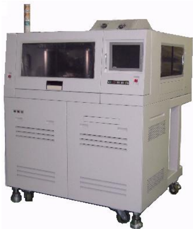
A/H543 : 4個同時測定、常・高温タイプの高速型
