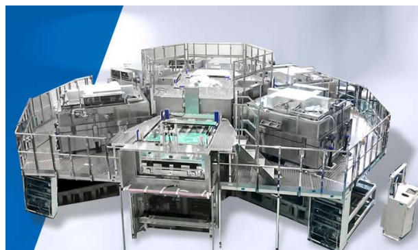
G6高密度ドライエッチング装置外観
