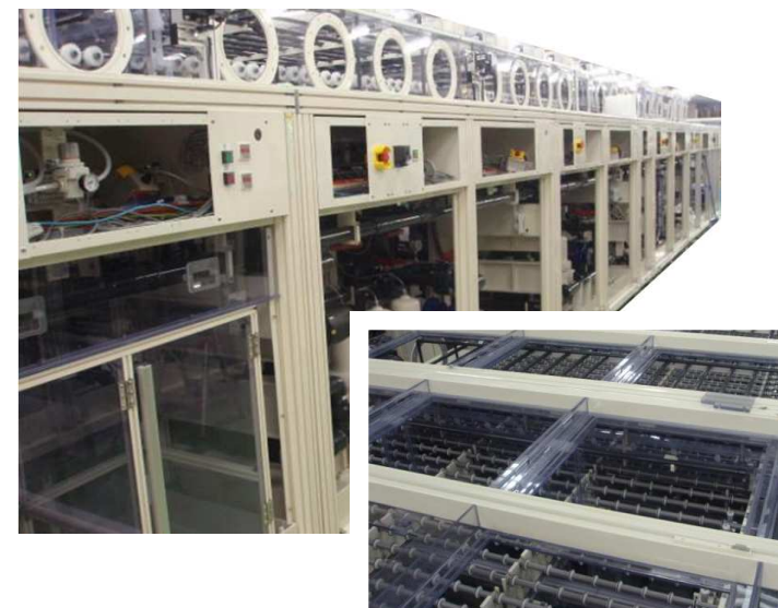
ウェットエッチング装置
