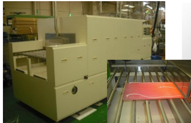
自動車関連ハイテンション鋼板 ローラーハース式加熱炉 多段式加熱炉
