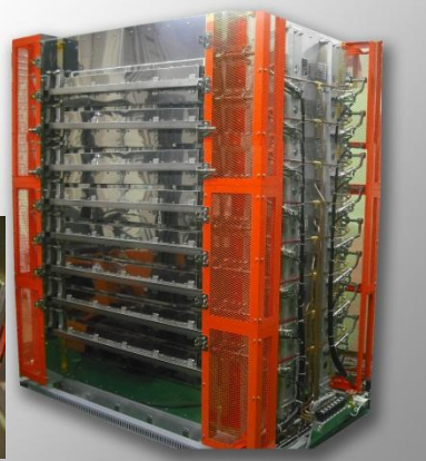
自動車関連ハイテンション鋼板 ローラーハース式加熱炉 多段式加熱炉
