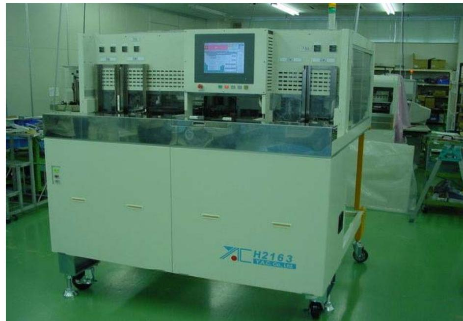
ICテストハンドラー(16個同時測定・常・高温タイプ)
