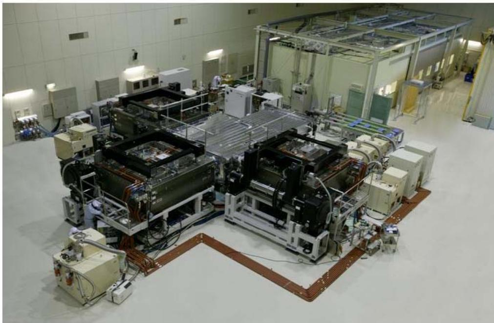
第7世代用プラズマ・ドライ・エッチング装置(3チャンバータイプ)
