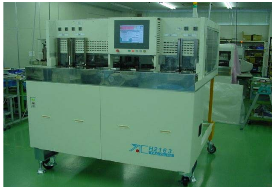
ICテストハンドラー(16個同時測定・常・高温タイプ)
