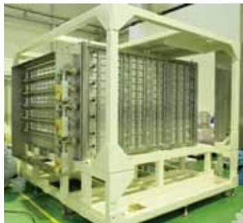
YHAシリーズは今後のIGZOパネルプロセスのKeyとなるバッチタイプの熱処理装置です。量産性と高品質な熱処理とを兼ね備えておりG6サイズまでの基板に対応しております。お客様のご要望もあり、G8サイズの装置の開発を進めています。
