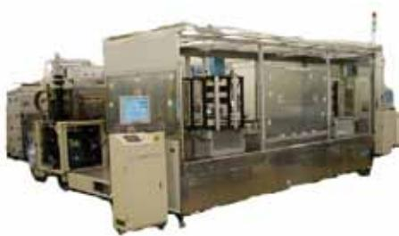
Plasma技術を用いた、ドライエッチング装置は、LTPS、OLEDといった、スマートフォン向けの高精細加工をはじめとして、製造プロセスの効率化や省マスク技術、大型化などに最適なプラズマエッチング装置です。
