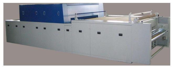
大口径圧カローラー採用 - 接着難素材への対応 ※0.5Mpaで84N/cmの加圧力 蒸気ヒーターor電熱ヒーターの選択 - 蒸気ヒーター選択時ランニングコストは電熱ヒーター比約1/5 ※1 ヒーターリフト機構 - 起毛素材の高品質な接着が可能
