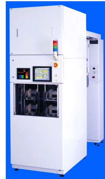
Vertical diffusion furnace
